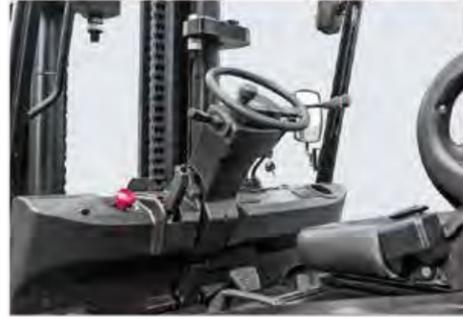
/ Der ergonomisch gestaltete einstellbare Lenkradwinkel und der einstellbare Sitzabstand von 150 mm bieten einen besseren Fahrerkomfort für verschiedene Fahrer.
