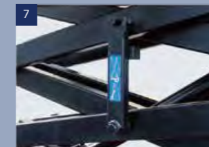
Stützarme: Zum Schutz des Bedieners bei Reparatur- oder Wartungsarbeiten
