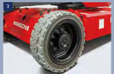
3 Reifen: schaumgefüllte Reifen mit guter Geländeleistung
