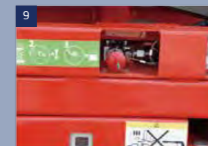
Manuelles Absenkenventil: Wenn das Betriebssystem ausfällt oder die Batterieleistung zu niedrig ist, um die Plattform sinken zu lassen, können wir dieses Ventil zum Absenken der Maschine verwenden
