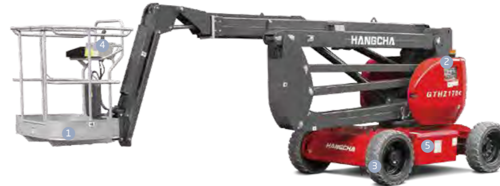
2 Basis-Kontrollkasten: Der Kontrollkasten kann verwendet werden, um jede Aktion des Geräts leicht verständlich zu steuern
