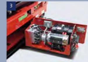
Hydraulisches und elektrisches System
