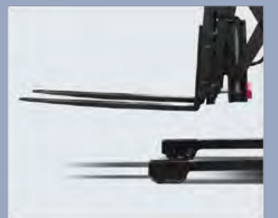
Proportional gesteuerte Gabeln können genauer betrieben werden
