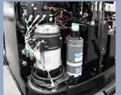
EPS (Electric Power Steering) ist Standardspezifikation
