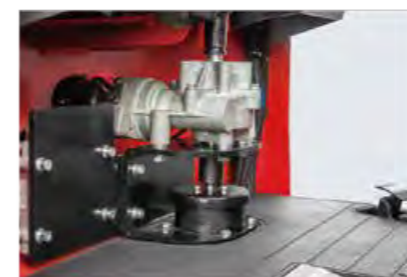
Elektronisches Servolenkungssystem (für Stand-Up-Traktoren)
