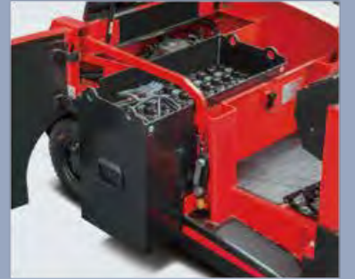
Das Ausrollen der Batterie ist die Standardkonfiguration, um die Batterie einfach und schnell auszutauschen
