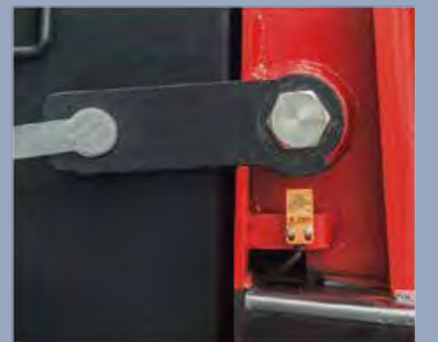
Die Verriegelung der Batterie ist mit der Sicherheitsschutzfunktion versehen. Nur wenn die Verriegelung gedreht ist, kann der Traktor fahren
