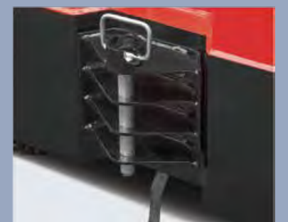
Aufgrund der speziellen Konstruktion kann die Zugvorrichtung verhindert, dass sich der Zugstift während der Fahrt löst
