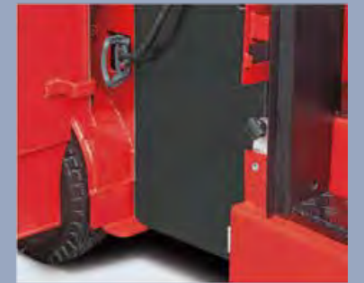
Die Batterie kann aus dem LKW entfernt werden Seite, so ist es sehr praktisch für die Batterie Instandhaltung
