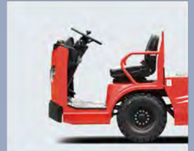
Vollgefederte Arbeitsbühne, Vibrationen werden reduziert, Geräusche werden isoliert
