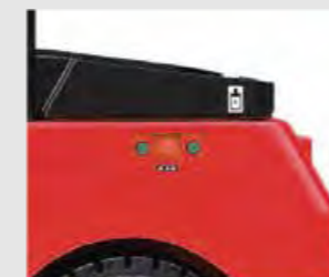
Vorwärts- / Rückwärts-Inch-Schalter und Notschalter sind links hinten montiert, sie machen Sie den Haken einfach und sicher
