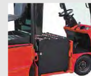
Seitenwechsel Batterie Design ist praktisch zum Batteriewechsel
