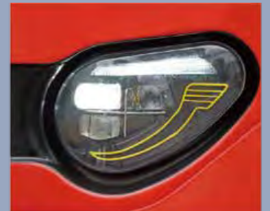
LED-Scheinwerfer hat die Funktionen Scheinwerfer und Abblendlicht. Das vordere Blinklicht nutzt die neueste Stream-Light-Technologie
