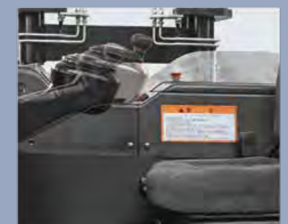
Das Lenkrad ist ausziehbar, so dass der Fahrer die beste Fahrposition wählen kann
