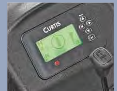
Das Instrument kann den Lenkwinkel und die Lenkrichtung synchron anzeigen
