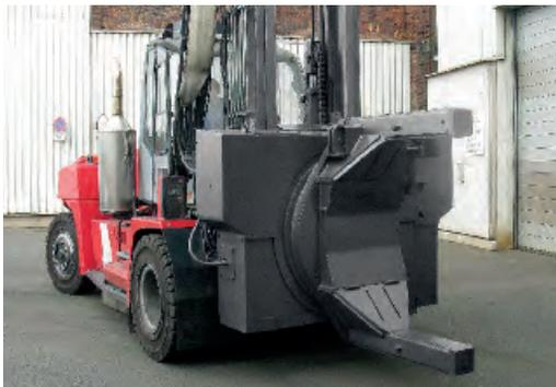
Drehgerät in Gießereiausführung mit Vollschutz und Konverteraufnahme
