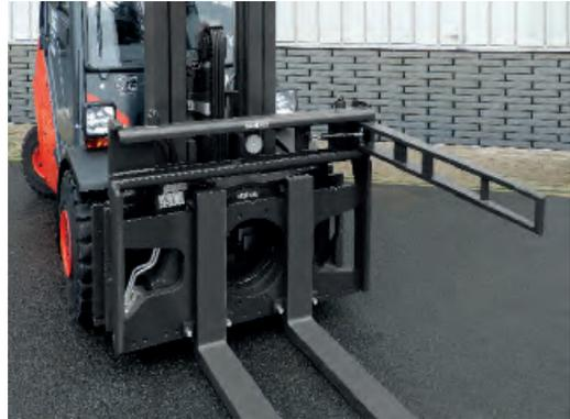
Drehgerät mit seitlichem Stützarm; manuell verstellbar,
