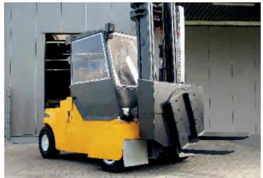
Drehgerät mit Seitenschub in Gießereiausführung und Wiegesystem
