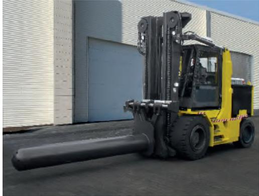
Hydraulisch teleskopierbarer Tragdorn
